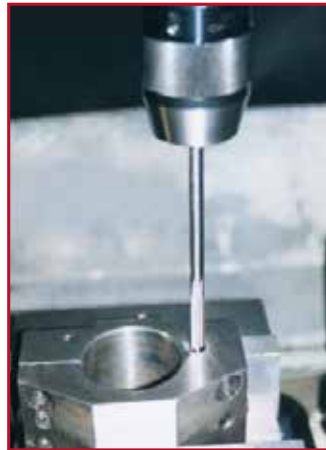
Vorbereitete Bohrung reiben, \varnothing -0 bis -0,05
